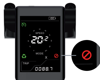
Le code d'erreur est actif, la valeur apparaîtra dans la section A, les détails seront expliqués dans le tableau des codes d'erreur page 59
